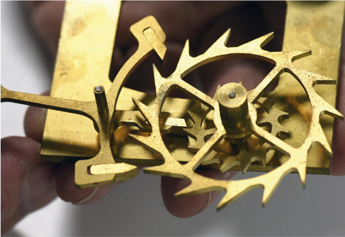
Abb. 31: Ein Modell der Gerber-Hemmung. Zwei koaxial positionierte Hemmungsräder, zwei Steine stoppen das Ruherad und ein Stein schiebt das Impulsrad an.
