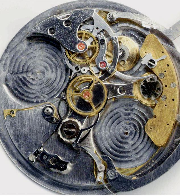
Abb. 13: Der neue Chronographen-Mechanismus wurde zu Testzwecken auf eine Dummy-Platine montiert.
