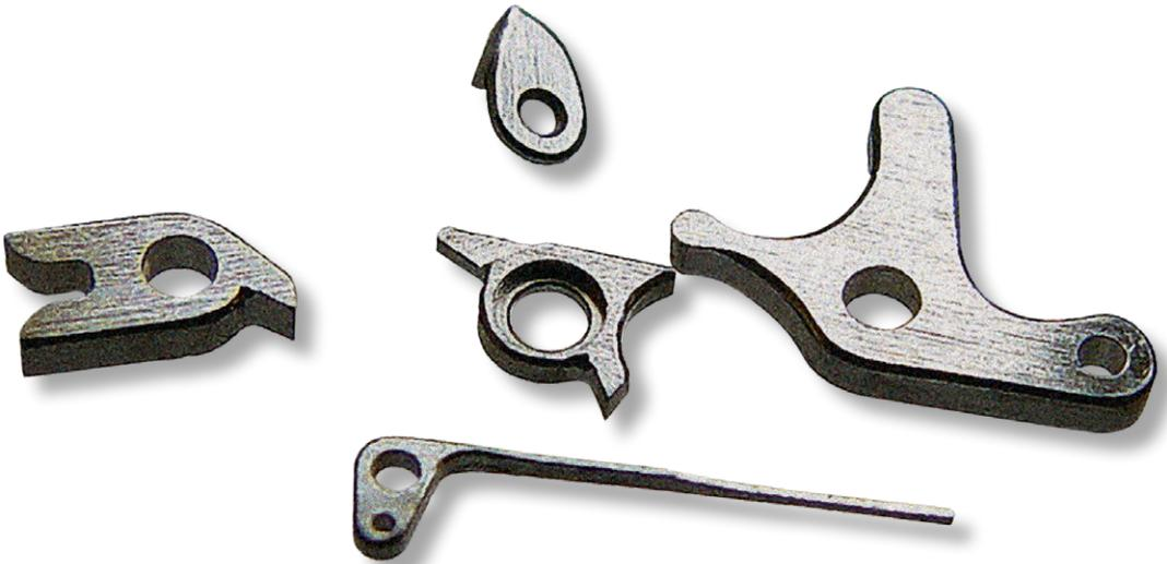
Abb. 27: Gerber stellte fünf zusätzliche Teile her, um die Einstellrichtung der Mondphasenanzeige zu ändern und den Schaltvorgang der Mondphase zuverlässiger zu machen.
