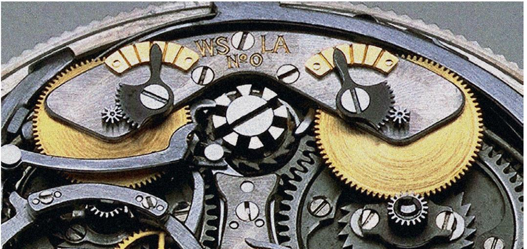
Abb. 15: Das Gangreserveanzeige-Modul für Geh- und Schlagwerk nimmt um das Chronographen-Schaltrad herum Gestalt an.
