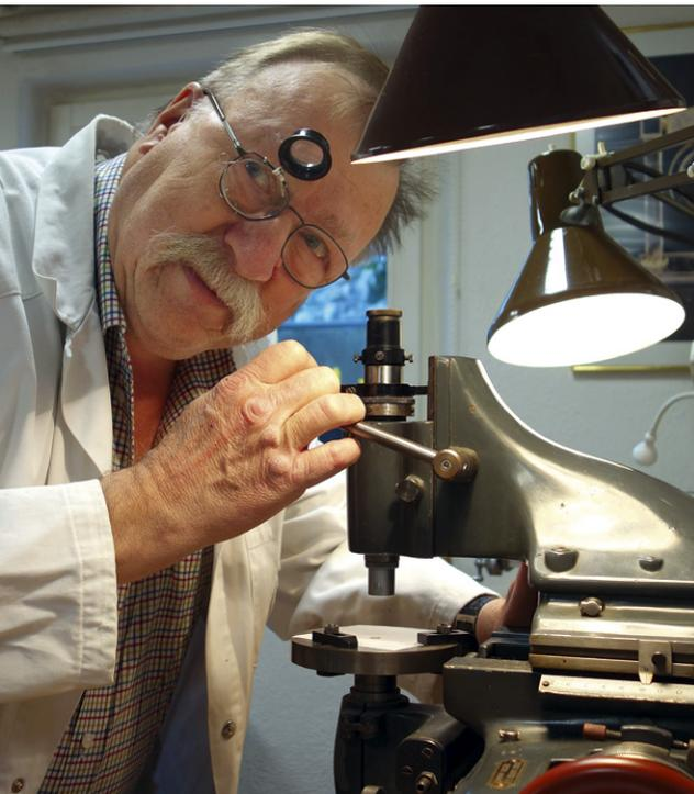
Abb. 7: Paul Gerber beim Ausmessen von Uhrwerkteilen am Koordinatenmessstisch Typ Hauser I.
