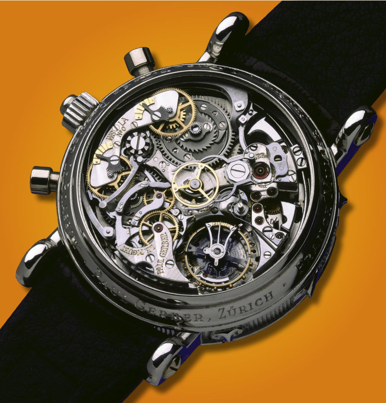
Abb. 24: Ein erhöhter Gehäuseboden und ein neues stärker gewölbtes Saphirglas waren die Folgen des Anstieges der Werkshöhe von 10,8 auf 13,4 Millimetern.
