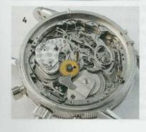
le für Präzisionsmaschinenbau: In die Achse des Chronozentrumrades, das einen Außendurchmesser von 0,5 mm aufweist und ein Durchgangsloch von 0,3 mm Durchmesser aufweisen muss, musste die Sekundenzeigerachse hineingebohrt werden.
