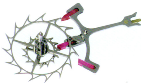
Die Gerber-Hemmung: Das zusätzliche Gangrad ermöglicht die Aufteilung in Ruhe- und Impulsrad. Es wird einseitig angetrieben.
