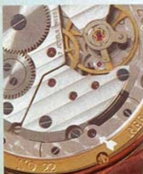
In dem gravierten Zusatzring ist die komplette Mechanik für die retrograde Sekunden untergebracht. Deutlich sichtbar die Lagerung für den Sekundenzeiger (Pfeil).
